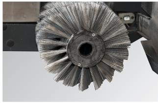
Robuste et grande brosse centrale Ø300 mm auto-nivelante à pression réglable et rotation "antihoraire". Unité de brosse en acier inoxydable. Système innovant de AIR RECOVERY (breveté) : grâce à l'air comprimé acheminé devant la brosse, la dispersion latérale de la solution de nettoyage est évitée.
